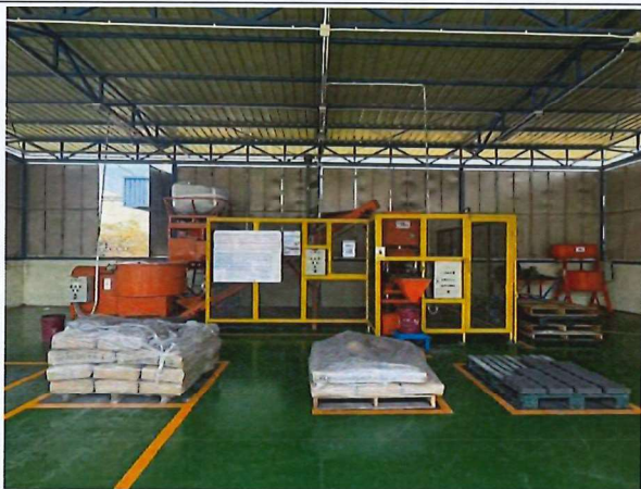
ภาพที่ 56 การทำอิฐบล็อกจากทรายเสื่อมสภาพ
