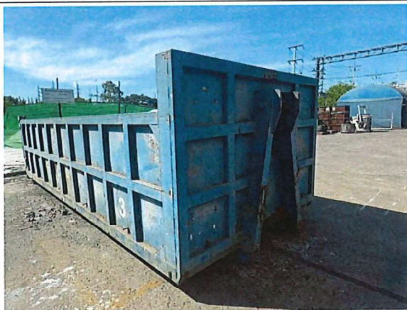
ภาพที่ 61 ภาชนะสำหรับจัดเก็บตะกรันจากเตาหลอม
