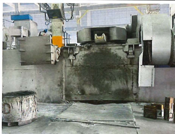
ภาพที่ 45 ป่อสำรองฉุกเฉินใต้เตาหลอม
