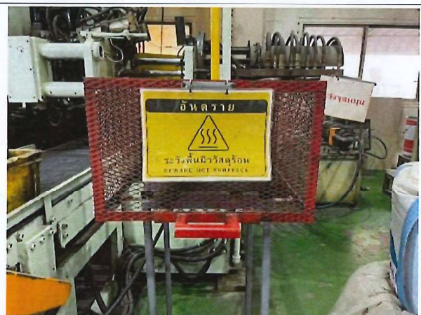
ภาพที่ 57 ป้ายเตือนแหล่งกำเนิดความร้อนสูง
