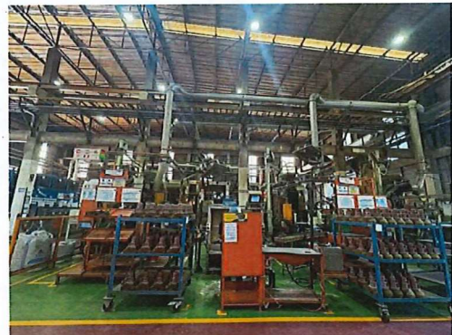
ภาพที่ 53 ระบบรวบรวมอากาศ บริเวณเครื่องผลิตไส้แบบ (Shell Core)
